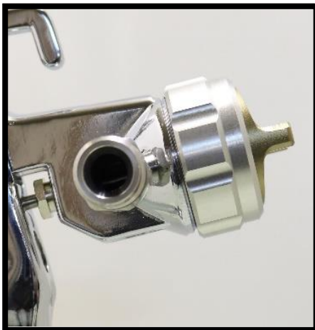
高粘度の塗料に対応する 大口径ニップル
