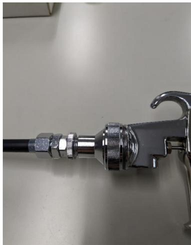
次に、FVノズル本体を奥までしっかりと取付けます。(手で回して、途中で止まれば、最後に少しだけ強く締めて終わりです。取付ける際はスパナで締めず、手締めして下さい。)
