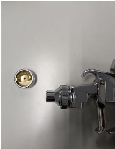
スプレーガンの空気キャップを外して、FVノズルのアダプターのみを取付けて下さい。(この時アダプターがスプレーガンのネジ部に奥まで入りきらずネジが余っても大丈夫です。)
