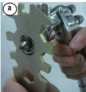
塗料ノズル分解時工具は付属品の専用スパナ
