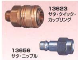
13623 サタ・クイック・カップリング 13656 サタ・ニップル サタ・クイック・カップリングセット エア圧が落ちないように内径φ6mmに設 定されています。 ニップルはシールテープを使用しなくても、 エア漏れのしない二重構造になっています。
