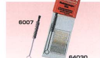
6007 サタ・クリーニング・ブラシ 64030 サタ・クリーニング・セット スプレーガンの手入れには、クリーニングブラシをご 使用ください。エアークリップ、塗料ノズルに付着した 塗料を使用後ラッカーシンナーなどに浸して、キズを つけないように洗浄してください。
