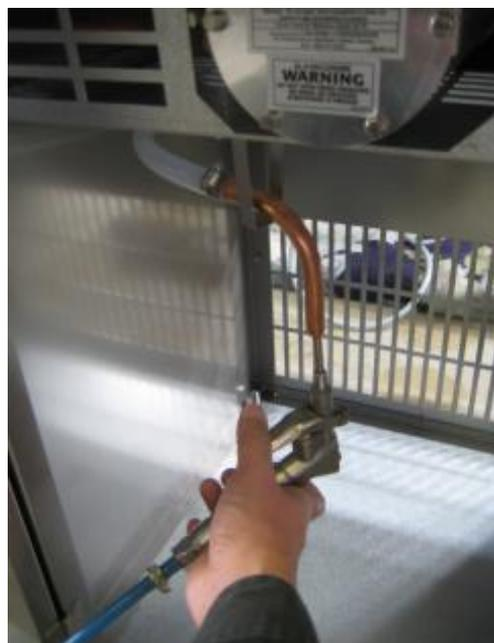
4. 本体下部扉内の再生液排出口から左記画像の様にエアージェットでエアープローを行って下さい。蒸気取入口から蒸留タンク内に勢い良くコンデンサー配管内に残った少量の再生液が出てきます。蒸気取入口から液が出てこなくなるまでブローして下さい。
