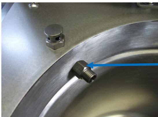
3. 蒸気取入口コネクタキャップを取り外した状態にして下さい。
